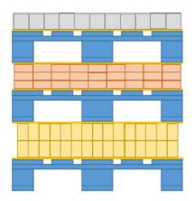
Une couche intermédiaire supplémentaire en carton ondulé est introduite entre la palette et la marchandise afin de sécuriser cette dernière. Pour sécuriser la pile de palettes sandwich, celle-ci est enveloppée dans un film étirable. L'enveloppement des différentes palettes sandwich n'est pas possible, sans quoi les piles ne pourraient être transportées en toute sécurité. Un enveloppement individuel supplémentaire n'est techniquement pas possible car la feuille resterait collée.
